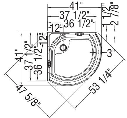
Toutes ces dimensions sont approximatives. Afin d'assurer une installation parfaite, les dimensions de la structure doivent être vérifiées à partir de l'unité.
