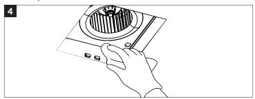
4. Humectez un linge avec du savon à vaisselle, nettoyez le boîtier du ventilateur et essuyez-le à l'aide d'un linge sec.
